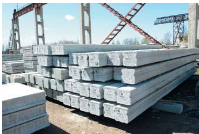
Рис. 2. Образцы железобетонных изделий ЗАО «СТРОЙСЕРВИС», производимых по новой технологии безопалубочного непрерывного виброформования на оборудовании, изготовленном и поставленном ЗАО «СТМ»
