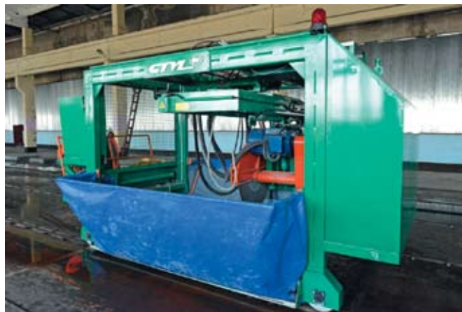
Рис. 1. Основные агрегаты линий ЗАО «СТМ» безопалубочного непрерывного виброформования
