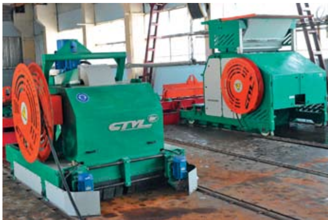
Рис. 1. Основные агрегаты линий ЗАО «СТМ» безопалубочного непрерывного виброформования
