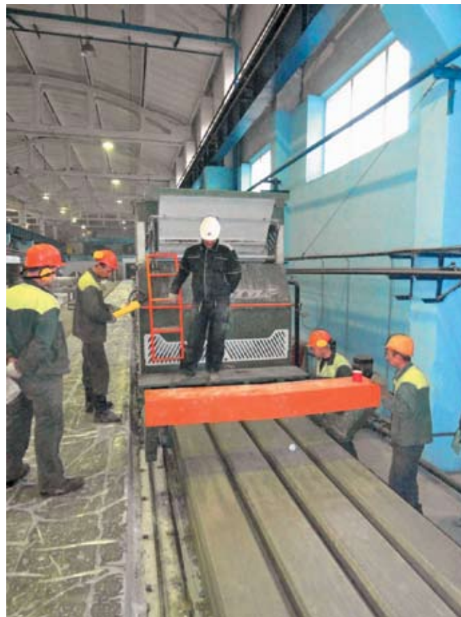
Рис. 3. Изготовление свай с использованием технологии виброформования «в один прием», г. Киров
